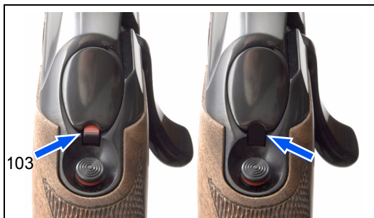
Рис. 4, Индикатор взведения 103 затвора каморы (слева: взведен, справа: опущен)
